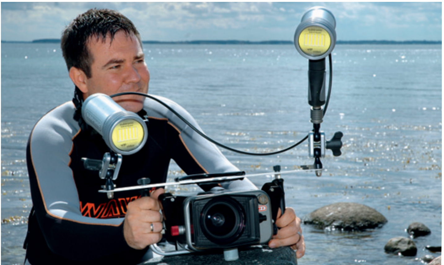
Test in der Ostsee • Einmal die Version mit eingebautem Akku (oben) und der optionale Akku-Container, der auf die obere Platte des Gehäuses montiert werden kann
