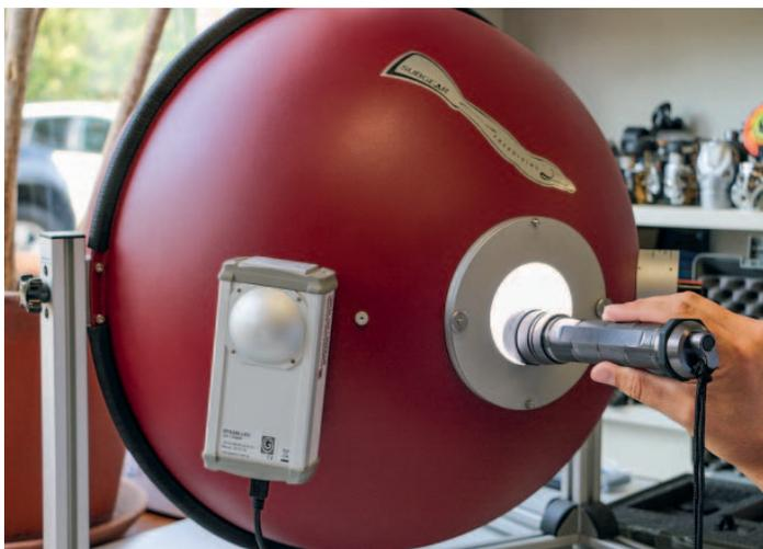
Die Messung in der Ullbricht-Kugel sorgt dafür, dass die angegebenen Lumenwerte der tatsächlichen Lampenstärke entsprechen.
