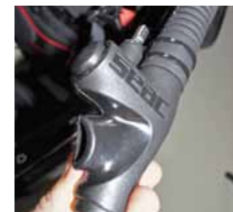
▲ Der Kugelventilinflator „SCS“ soll kaum anfällig für Verschmutzungen sein.
