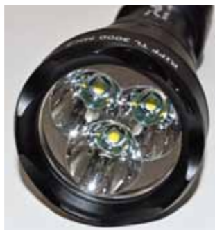
Die drei LEDs lassen sich über den Magnetschalter (links) in vier Stufen regeln – außerdem hat die „Riff TL-3000“ verschiedene SOS-Signale.
