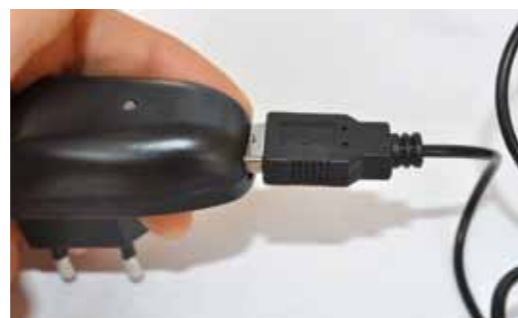
Die Ladestation der „Riff TL-3000“ versorgt den Akku über Stecker oder USB-Anschluss. Der Vorteil: Ein defekter Stecker kann sehr kostengünstig ersetzt werden und die Lampe lädt auch über den PC auf.
