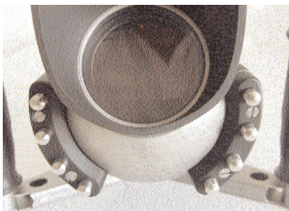
Beim Test-Prototyp waren die Verschlüsse scharfkantig und die Bedienelemente nicht beschriftet. Beim Serienmodell soll das geändert werden
