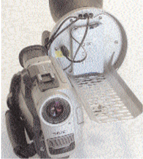
Drei Stecker stellen dank LANC-Technologie die Kommunikation zwischen Gehäuse und Camcorder sicher
