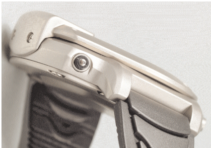
Etwas versteckt sitzt der Wassersensor des „NiTek C“
